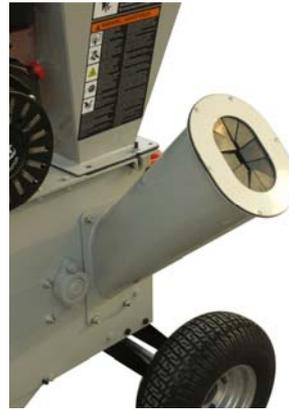
El canal lateral es para piezas más largas y/o gruesas de desperdicios de patio. Dependiendo del número de modelo, la trituradora/desmenuzadora puede cortar piezas de madera de hasta 3" o 4" (7,6 cm o 10,2 cm) de diámetro.
