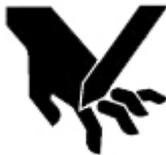
Esta máquina tiene cuchillas giratorias de corte capaces de amputar las manos y los pies así como de lanzar objetos. Conserve las manos y los pies fuera de las aberturas mientras la máquina esté en funcionamiento. La inobservancia de estas instrucciones de seguridad podría ocasionar lesiones graves o la muerte.
