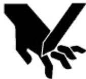
Cette machine est équipée d'une lame rotative coupante capable d'amputer une main ou un pied, et de lancer des objets. Éloignez les pieds et les mains des ouvertures pendant que la machine est en fonctionnement. L'inobservation de ces instructions de sécurité peut être à l'origine de blessures graves, voire mortelles.
