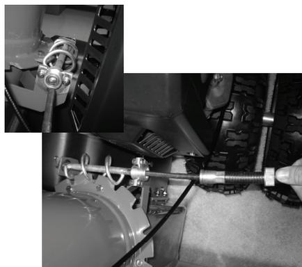
3. Alignez la section centrale avec le câble du rotateur de la goulotte. L'extrémité de la section centrale est carrée et nécessite un alignement adéquat aux fins d'un bon raccordement à la machine.
