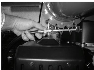
5. Faites glisser l'extrémité filetée de l'étape 2 vers le rotateur de la goulotte, puis faites passer l'extrémité sur ce dernier.
