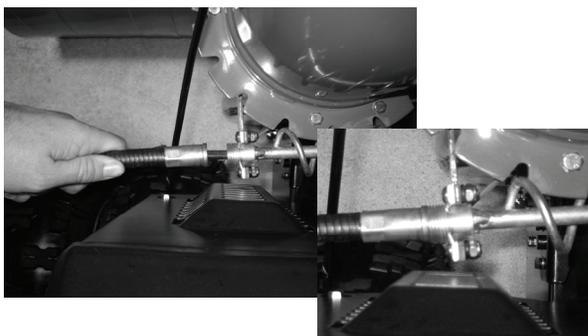
4. Appuyez sur le câble vers le rotateur de la goulotte. L'extrémité du câble doit toucher le bout du rotateur de la goulotte.
