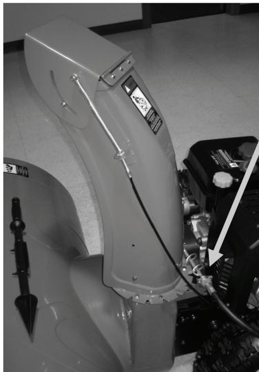
1. Localisez le raccord : le raccord du câble de rotation de la goulotte est situé à la base de la goulotte entre celle-ci et le moteur.
