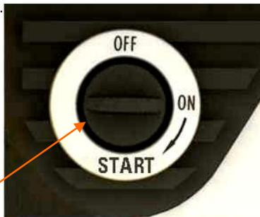
Interruptor de encendido, apagado (ON / OFF) y arranque del motor
